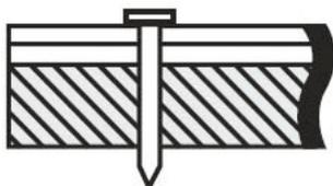
Рис. 2 Пример правильной забивки гвоздей при монтаже продукции.
